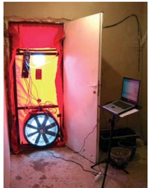
Fot. 3. Urządzenie Blowerdoor gotowe do próby
